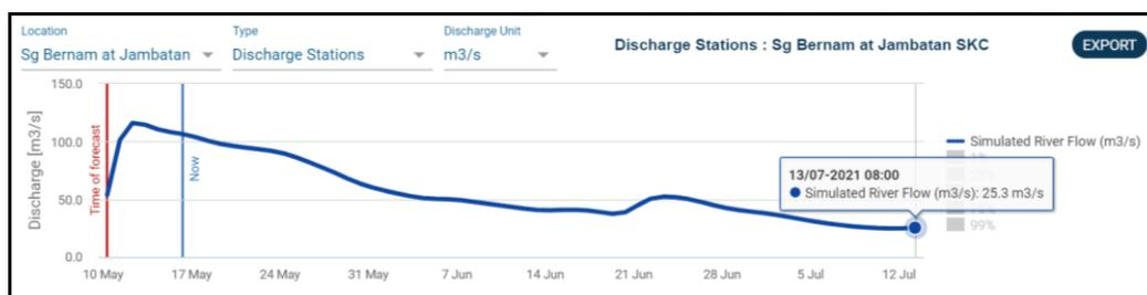
Rajah 14 - Ramalan Kadar Alir di Jambatan SKC untuk 2 Bulan Ke hadapan
