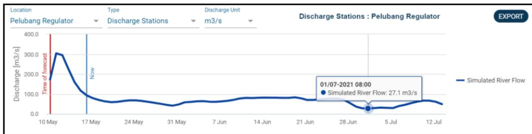
Rajah 10 - Ramalan Kadar Alir di Pelubang untuk 2 Bulan Ke hadapan
